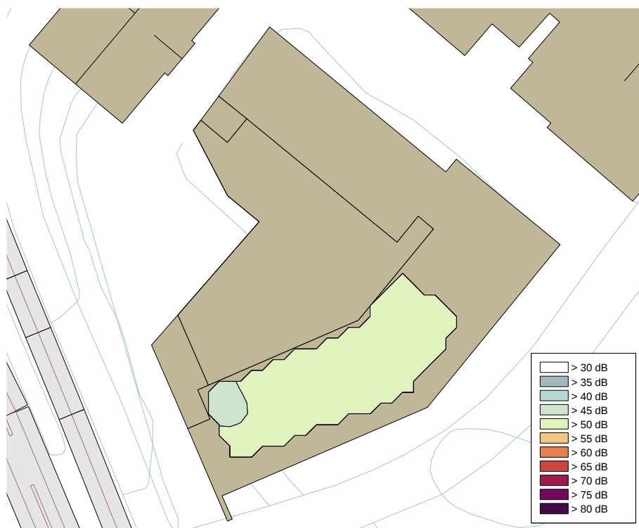
Figur 35: Lydnivå i 1,5 m høyde over planlagt takterrasse. Grenseverdi er L_{den} 55 dB for vegtrafikk.
