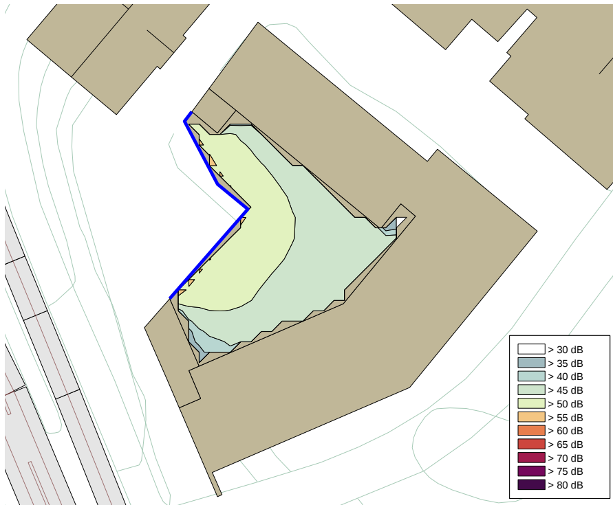
Figur 34: Støykotekart for vegtrafikk i 1,5 m høyde over planlagt uteoppholdsareal på lokk over kjelleretasje. 1,2 m høyt, tett rekkverk er vist i blått. Grenseverdi er L_{den} 55 dB for vegtrafikk.
