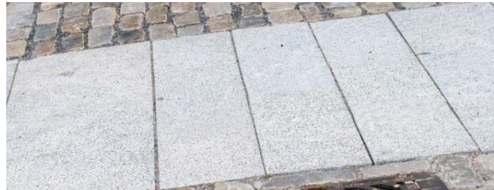
Lys granitt - benyttes i kantstein, vannrenner, kantbånd og -heller. Jevn overflate.
