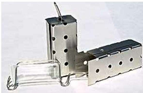
Figur 3: SPMD-membran i engangsbur (foto: ALS Laboratory Group).
