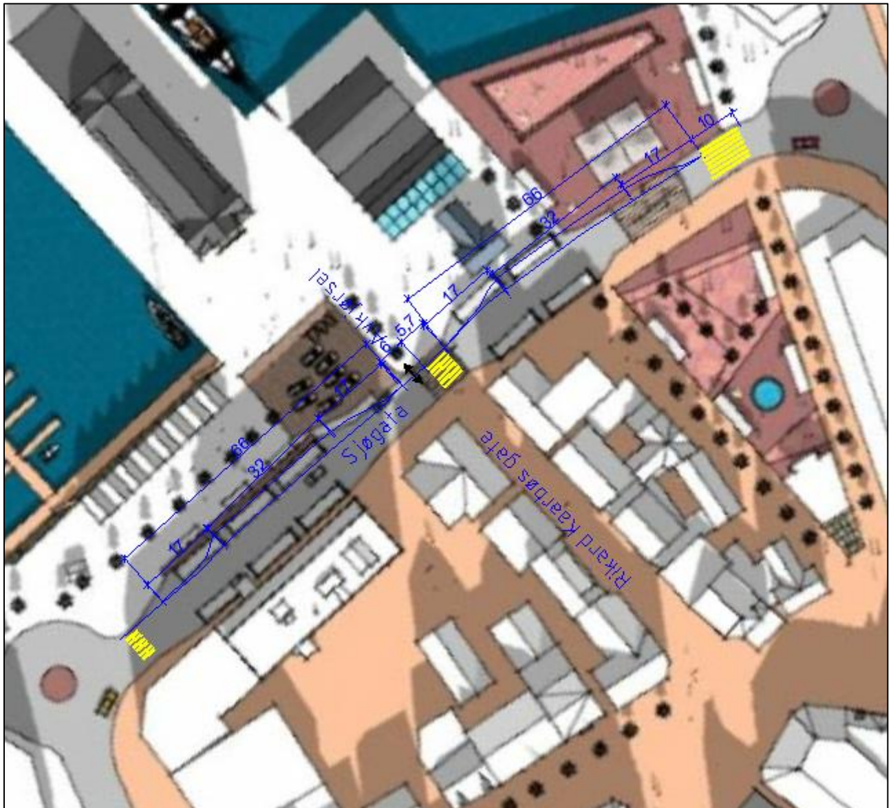
Figur 10. Anbefalte dimensjoner for holdeplassgate 2+2 holdeplasser på hver side. Ovenfor er dimensjonene tegnet inn i blått for holdeplasser som følger vegvesenets utbedringsstandard. Avkjørsel for drosjeoppstilling flyttes og gangfeltbredden reduseres i forhold til arkitekttegning.
