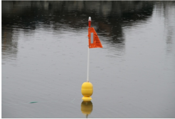
Figur 7. Foto av riggene som ble benyttet til utsetting av passive prøvetakere og blåskjell. Foto: Guttorm N. Christensen, Akvaplan-niva.
