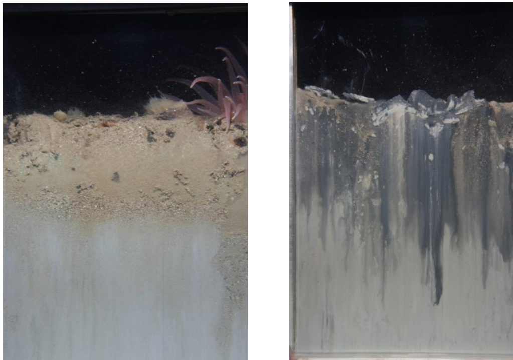
Figur 6. Bilde tatt av sedimentprofil ved hjelp av Sediment Penetrating Images (SPI). Foto: Akvaplan-niva.
